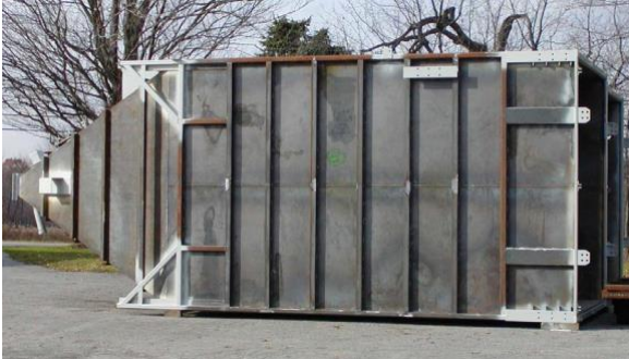
Ein katalytisches Filtermodul, welches auf der Baustelle angeliefert wurde und zum Anheben bereit ist.
